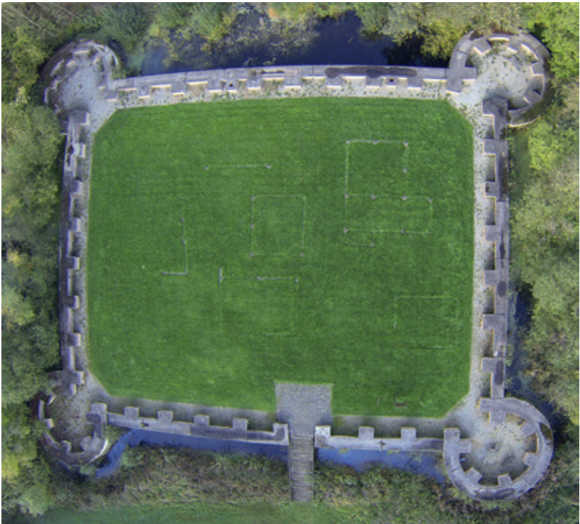
Op een luchtfoto worden de muren vervormd weergegeven. Dat heet het fish-eye-effect.
